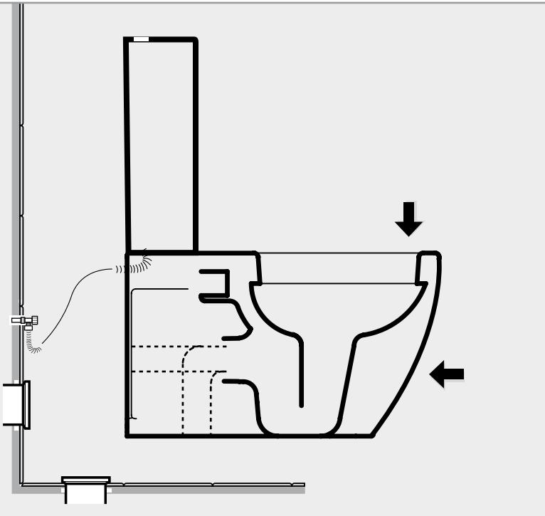
Posizionare il pezzo allineando lo scarico con il foro a muro o a pavimento a seconda della predisposizione. Contemporaneamente, inserire entrambe le connessioni, della cisterna e dello scarico del sanitario. ATTENZIONE: per agevolare l'innesto dei raccordi dell'entrata e uscita acqua si consiglia di lubrificare entrambe le parti.
