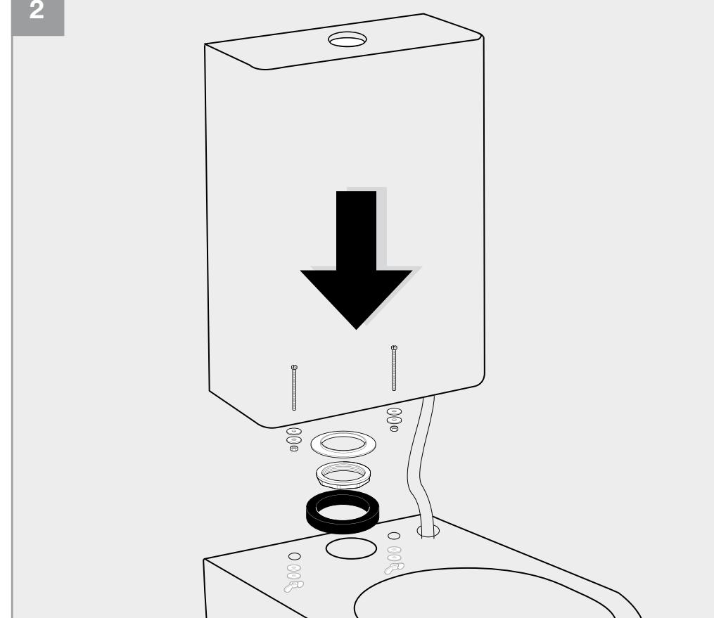
Installare la cassetta su sanitario con kit di fissaggio in dotazione. Frapporre tra il sanitario e la cassetta l'apposita guarnizione prima di fissarla.
