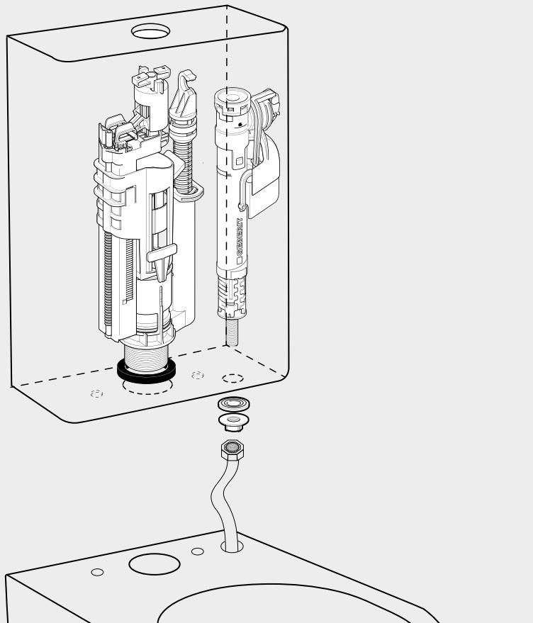
Per semplificare l'installazione, si consiglia di fissare il flessibile al galleggiante prima di bloccare la cassetta al sanitario e successivamente avvitare il flessibile sull'attacco a parete.
