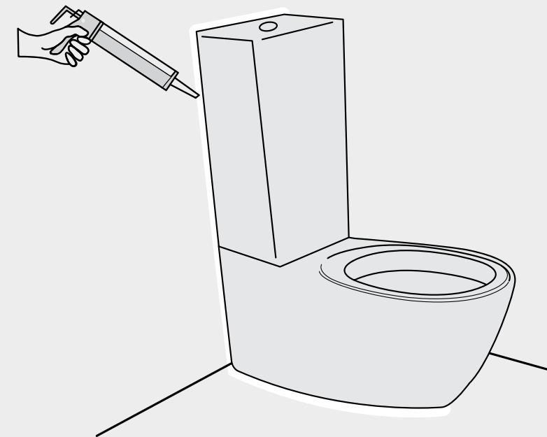
Appicare un leggero strato di silicone nel perimetro del sanitario che è a contatto con la cassetta di ceramica e il pavimento. Raccomandiamo di utilizzare un silicone universale anti muffa. Rimuovere gli eccessi di silicone aiutandosi con carta assorbente.
